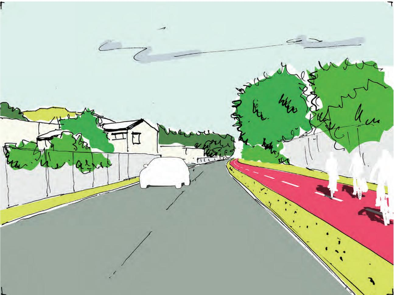
Abb. 34 Ideenvisualisierung Anlage eines abgesetzten 2-Richtungs-Radweges (Qu.: DTP)
