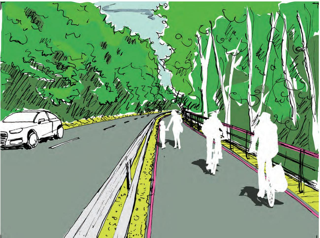
Abb. 32 Ideenvisualisierung Ausbau der Wegebreite mittels Kragarmkonstruktion (Qu.: DTP)
